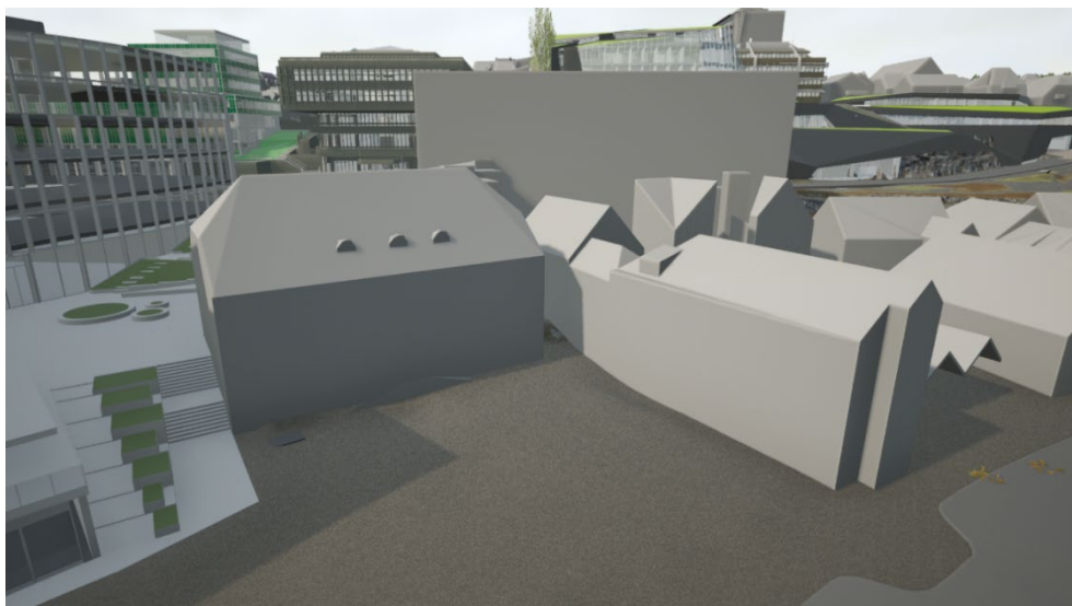
Figur 36. FKB-Bygg etter automatisk generering.
