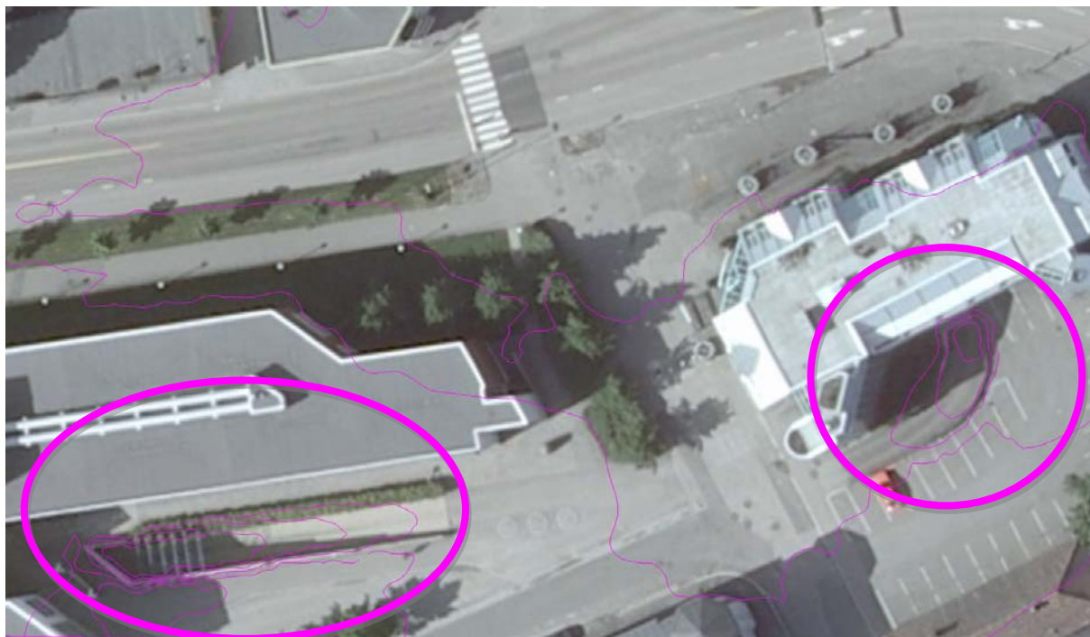
Figur 12: Eksempel på område (nedkjøringer til parkeringsgarasje) der det ofte er nødvendig å bruke FKB-data (murer, terrenglinjer etc.) for å kunne lage riktige høydekurver. Det bør drøftes hvor mye arbeid firma skal legge ned i å få til gode høydekurver i slike områder. Det samme gjelder for andre områder med tekniske anlegg (bruer, underganger etc.). I eksemplene på neste side vil dere se at det kan synes som om enkelte firma har feilklassifisert kurvene (høydekurve (heltrukket strek) i stedet for forsenkningskurve (stiplet kurve)).
