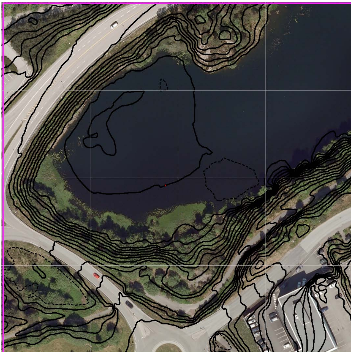
Figur 19: Eksempel på utfordring med generering av høydekurver i vann og hav. I dette testprosjektet har ikke firmaene hatt tilgang til vektordata som avgrensner vann- og kystkontur. Resultatet har dermed blitt at noen firma har fått kurver i vann. Her må det også sies at i LAS-dataene er enkelte av punktene i vann klassifisert som terrengpunkter (se figur neste side).
