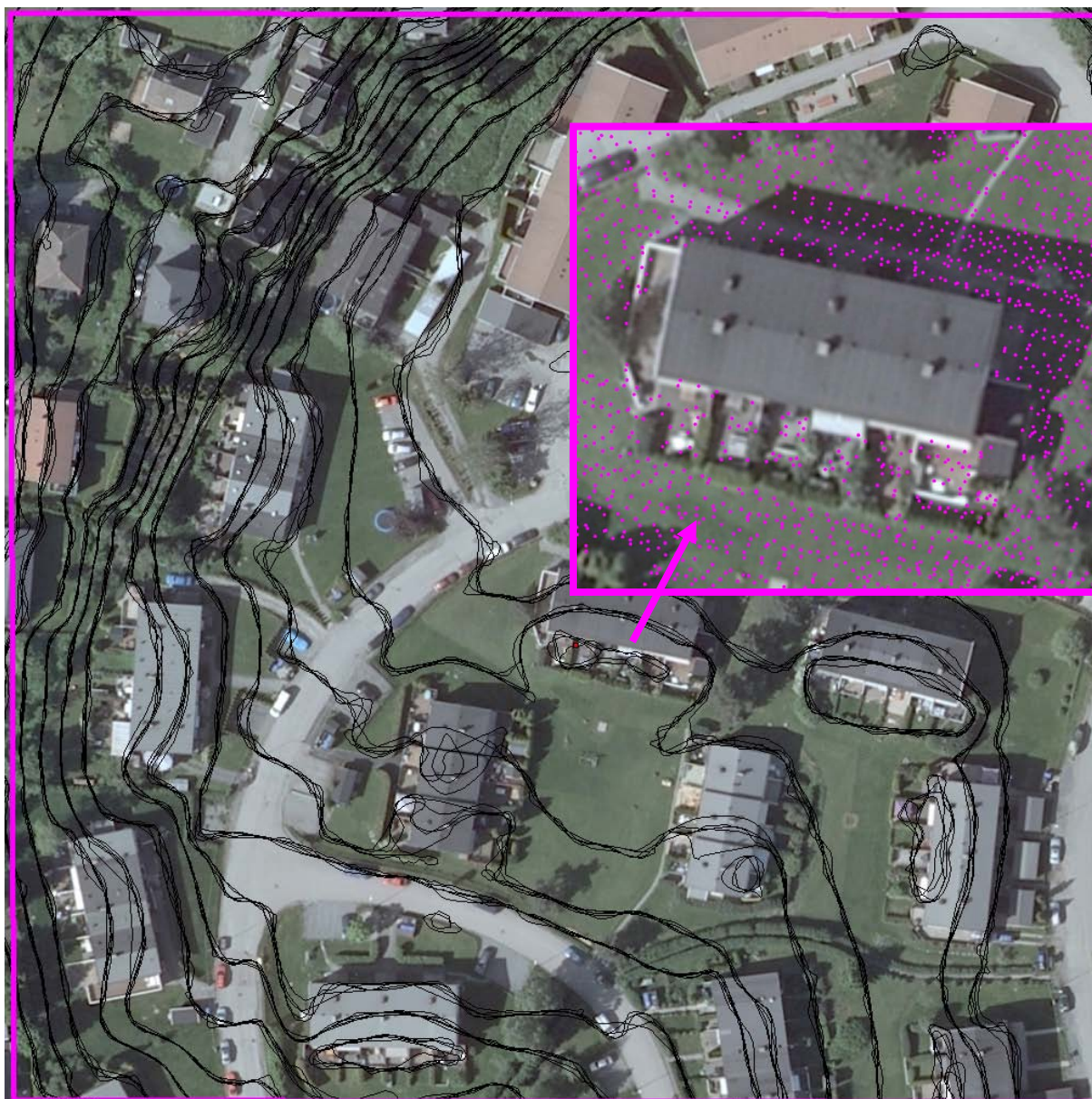
Figur 14: Høydekurvene fra alle firma presentert. Illustrasjonen viser at genererte høydekurver i bebygde områder med liten vegetasjon i hovedtrekk er like for alle firma. Legg merke til klassifiseringen av laserpunktene ved den ene bygningen. Det kan nok diskuteres om plattinger/terrasser i dette eksemplet burde vært klassifisert som terrengpunkter eller ikke. Dette eksemplet viser at det i en del tilfeller vil være vanskelig å klassifisere laserpunktene riktig og at man må forvente at feilklassifiseringer kan forekomme.
