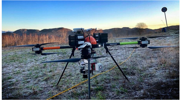
Figur 1 Feltbilde fra kartleggingen ved Hommersåk. Avbildet vår egenutviklede Staaker FX8 drone med Phoenix miniRanger sensor. Foto: Jon Moe, Kartverket
