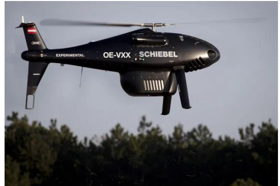
Figur 22 Camcopter S100 med Riegl VQ®-820-GU ( www.suasnews.com )
